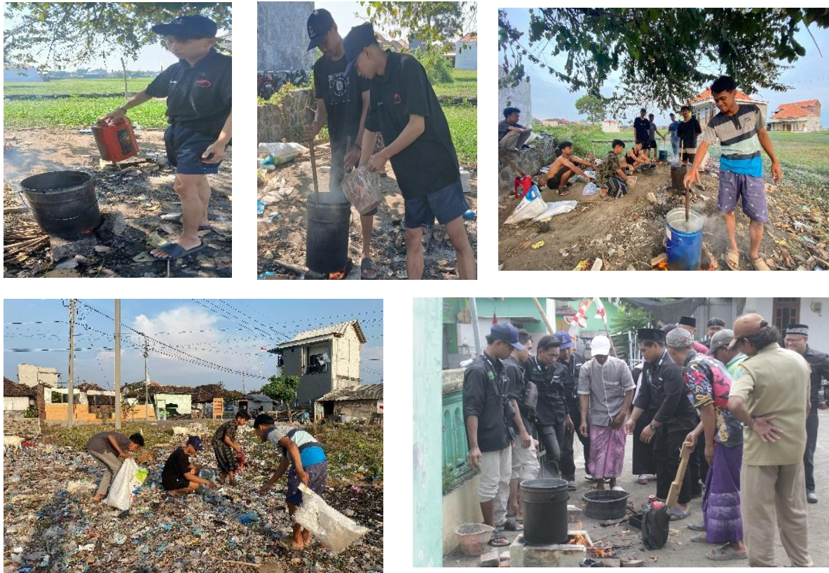
Gambar 3. Proses pencarian limbah plastic, Peleburan Plastik dan Pencetakan Paving Block oleh Peserta Pelatihan
