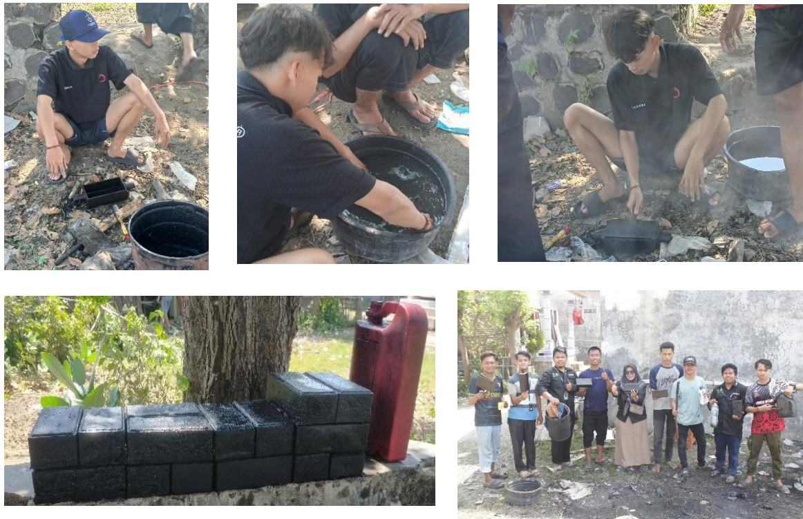
Gambar 4. Proses pencetakan dan Produk Paving Block Berbahan Limbah Plastik
